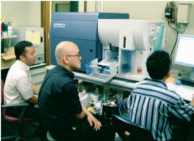
高次機能を有したセルソーター FACS Aria II が免疫学研究室に導入された（遺伝学部と共同購入）。造血幹細胞をはじめとする様々な細胞の分離解析や、染色体ソーティングを遺伝学部と共同で行っている。
