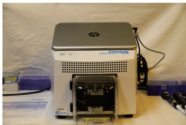
遺伝学部導入された DNA 断片化装置。コンピュータにより制御された高出力で安定した超音波により、高い再現性で DNA を目的とするサイズに断片化でき、必要とする DNA も少量である。次世代シーケンサーを使用した研究を行う際には、DNA の調製を行うために必須の装置である。
