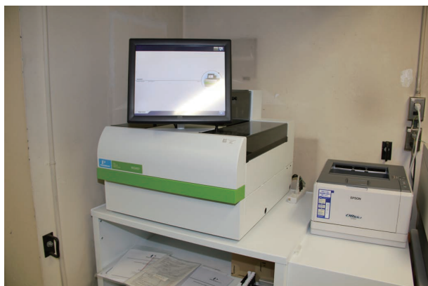
2470 Wizard 2 ガンマカウンタ。3.0 インチウエル型 NaI(Tl) ガンマ線シンチレーションカウンタは、 ^{125}\text{I} 、 ^{51}\text{Cr} などのガンマ線を効率よくエネルギーごとに検出して測定することができる。蛋白質や細胞の標識実験、汚染検査に用いられる。
