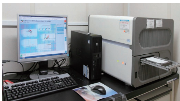
遺伝学部導入された 96 検体または 384 検体を一度に解析できるリアルタイム PCR 装置。他の手法により検出されたゲノム DNA におけるコピー数変異の検証や、次世代シーケンサーによる解析に必要な断片化されたゲノム DNA ライブラリーの正確な定量など、様々な用途に用いられている。
